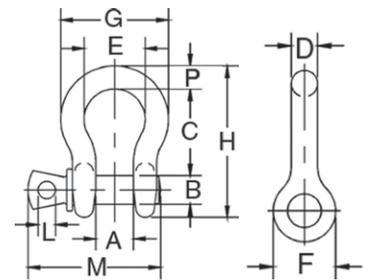
Ankerschäkel mit Schraubbolzen der Serie G-209 erfüllen die Leistungsanforderungen gemäß RRC-271D Typ IVA, Grad A, Klasse 2, jedoch mit Ausnahme der Bestimmungen, die vom Auftraggeber erfüllt werden müssen.
